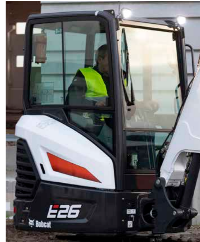
TOPS/ROPS/FOPS-Kabine mit Heizung
